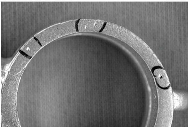
Abb. 3 | Typischer Gießfehler: Porosität
