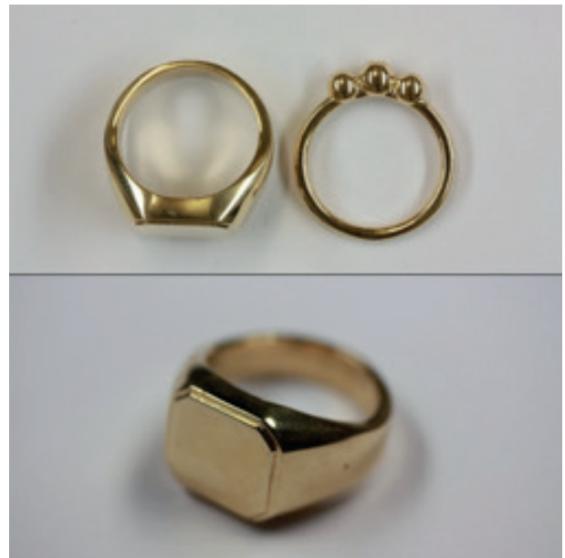
Abb. 5 | Fertig polierte Schmuckteile aus direkt gegossenen Kunstharzteilen
