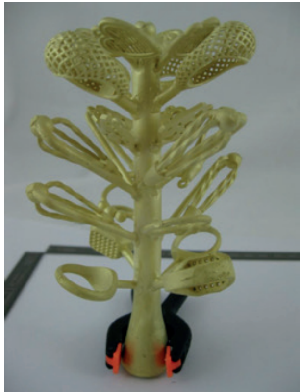
Abb. 4 | Typischer Gussbaum für das direkte Gießen von Kunstharzteilen
