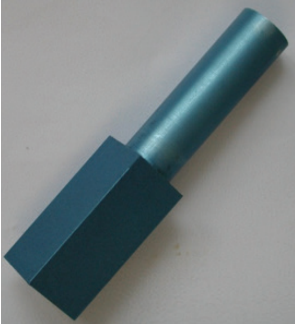
Abb. 2 | Scharnierbolzen aus EN AW-6060 im ecapierten Zustand. Oberflächenzustand: eloxiert und organisch eingefärbt
