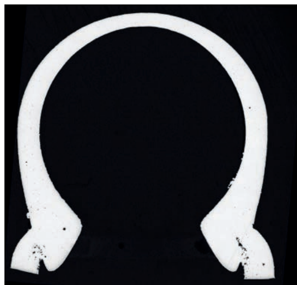
Abb. 4 | Porosität eines gegossenen Rings aus PtRu5 im metallographischen Längsschliff
