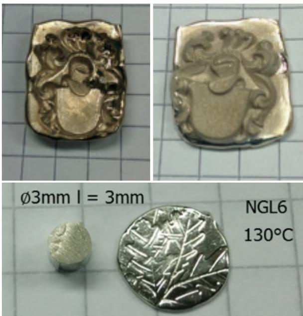
Abb. 3a | oben: thermoplastisch geformtes Wappen der Legierung Ausgangslegierung (Oliver Groß, LMW, Uni des Saarlandes); unten: abgeformte Münze mit der Legierung NGL6 (Oliver Groß, LMW, Uni des Saarlandes), unten: thermoplastisch gefügte Brosche aus amorphem Granulat
