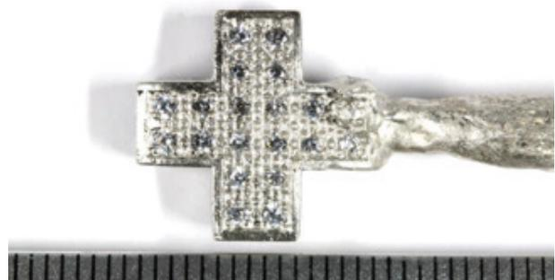
Abb. 4 | Auf Basis eines Wachsteils mittels Guss in verlorene Metallformen hergestelltes amorphes Schmuckstück mit Zirkonia
