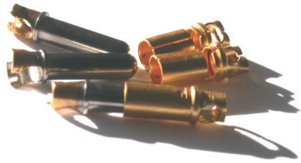
Abb. 3 | Silber-Palladium-Legierungsschichten als elektrische Kontaktoberflächen
