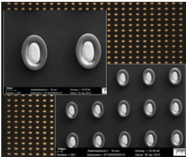
Abb. 2 | Komplett und homogen gefüllte SU-8 Strukturen nach den galvanotechnischen Prozessen (150 x 50 µm)
