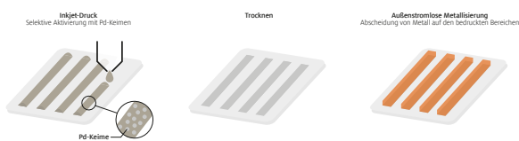
Abb. 1: Erzeugung von Leiterbahnen durch ein kombiniertes Verfahren von Inkjet-Druck und außenstromloser Metallisierung
