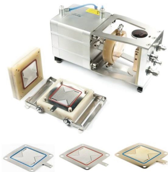
Abb. 3 | Modifizierte, kommerzielle Messzelle quickConnect von balticFuelCells für die Langzeitmessungen an den kohlenstoffbeschichteten metallischen Bipolarplatten ( www.zbt-duisburg.de )
