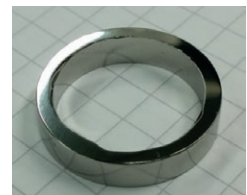
Abb. 2 | Im Labormaßstab hergestellter MMG-Ring aus Pt-basierter Legierung
