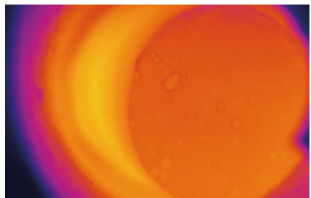
Abb. 3 | Aufschmelzen von Titanzylindern in keramischem Tiegel mit \text{CaZrO}_3 -Beschichtung
