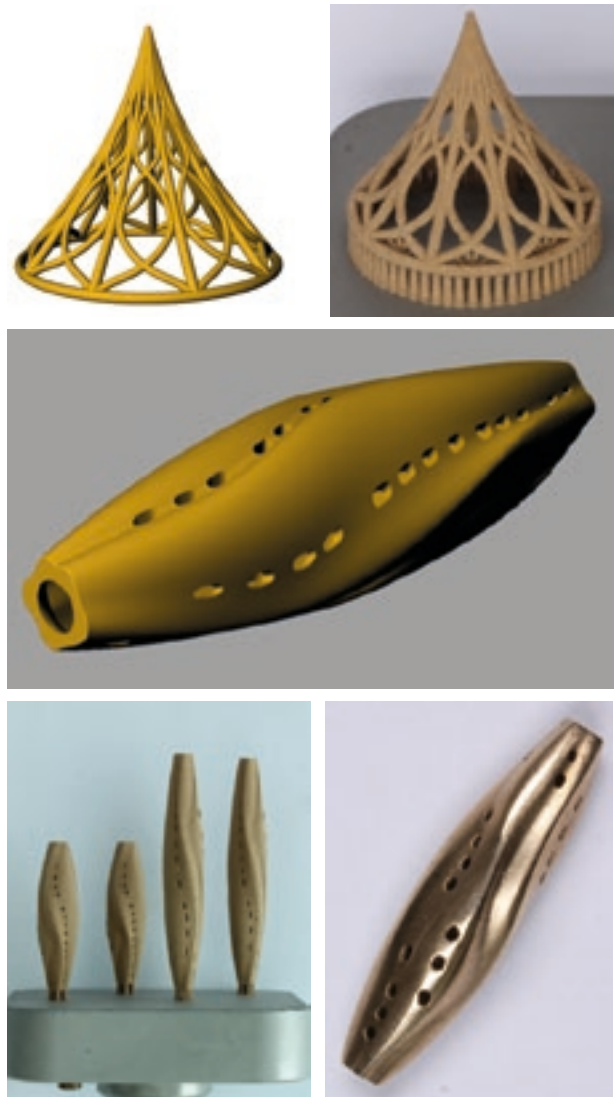
Abb. 1: Demonstratorbauteile aus einem Forschungsprojekt zur additiven Fertigung von Goldlegierungen aus Bronze (oben rechts, unten links) und Gold (unten rechts)
