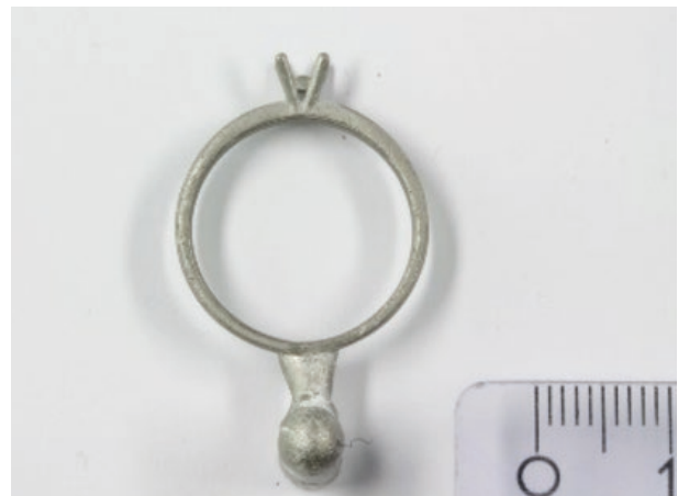
Abb. 2a: Gegossener Ring mit Anguss aus Pt_{42,5}Cu_{27}Ni_{9,5}P_{21}
