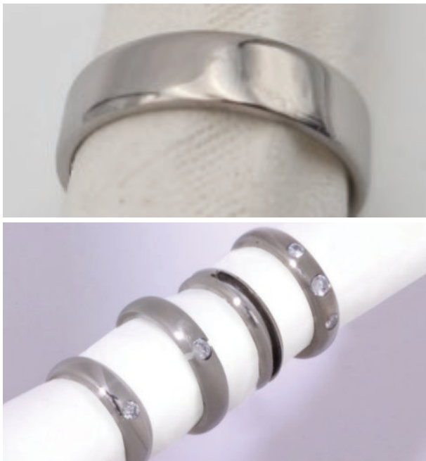
Abb. 3: Durch PA-Mitglied Barth 2 foryou professionell aufpolierter amorpher Ring der Legierung \text{Pt}_{58}\text{Cu}_{21}\text{P}_{21} (oben); im Druckgussverfahren hergestellte Ringe mit nachträglich gesetzten Steinen und Fräsungen aus Zr-basierten MMG (unten)
