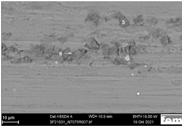
Abb. 3: REM-Oberflächenaufnahme AlZn5,5MgCu – EDX-Messung Stelle 5 und 6: Al, Mg, O
