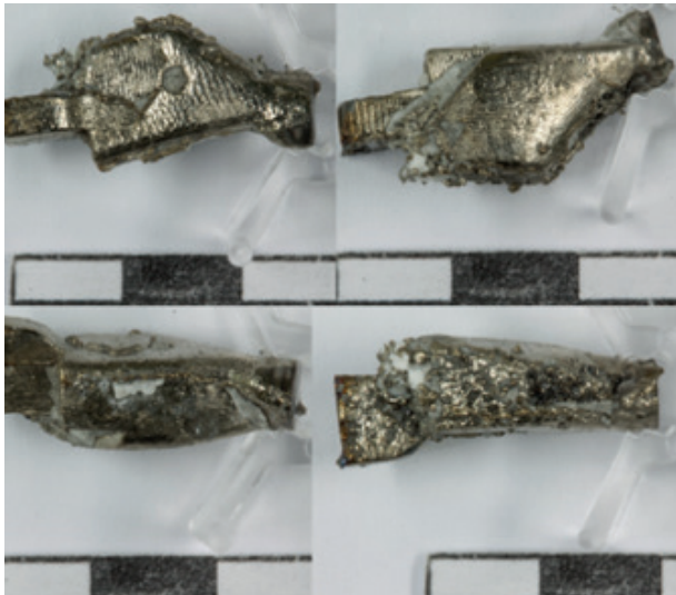
Abb. 2 | Brillenscharnier direkt nach dem Ausbetten. Abgüsse fanden mit Replica-Formschalen statt. Die Oberflächenqualität und Detailgüte ist sehr gut. Stellenweise sind Fahnen zu erkennen, die durch Fehler in der Frontschicht entstanden sind
